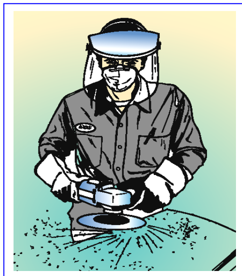
▲ 施工作業應注意機具使用安全，並穿戴個人防護裝備。
