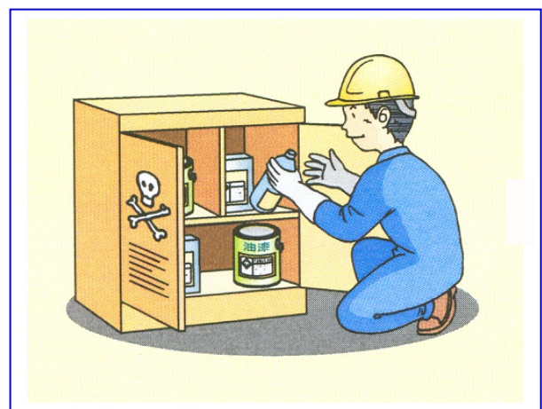
▲ 危險物品之使用應予以分裝管制，並選擇適當保管處所（遠離火源、密封、防範翻落及防火材料隔絕等措施），同時設專人負責管理，並嚴禁抽煙。
