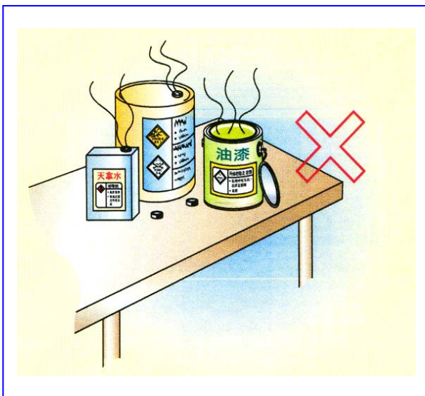
▲ 盛裝易燃性液體的容器應隨手蓋好，以免易燃性氣體充斥於施工場所內，造成火警或爆炸之危險。
